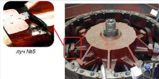
Фотии С.В. Определение причин и характера разрушения луча крестовины рабочего колеса гидроагрегата №3 Зейской ГЭС // IX НТК «Гидроэнергетика. Новые разработки и технологии». Санкт-Петербург. 2015.
